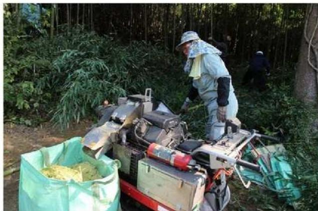
竹ヤブで、竹を伐採しその場でチップに加工します。
